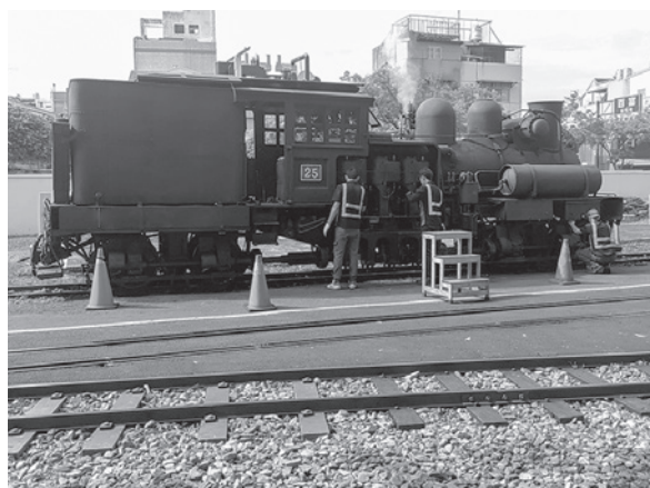
急勾配急曲線対応蒸気機関車。檜客車牽引に向けて運転整備中。林鉄本線北門駅
