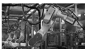
プリントチップに基盤や部品・ケースを組合せ、プリントヘッドを製造
