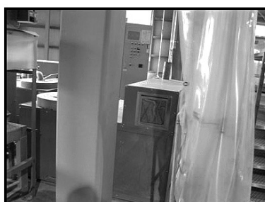
工場内の粉塵排気装置の 吸引装置（75～85dB騒音）
