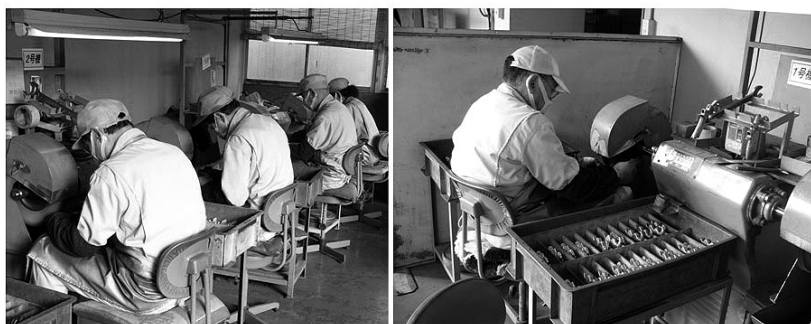
噴霧器鋳物の成形、研磨、艶出し作業 マスク、保護手袋、耳栓を着用（騒音レベルは85dB前後）
