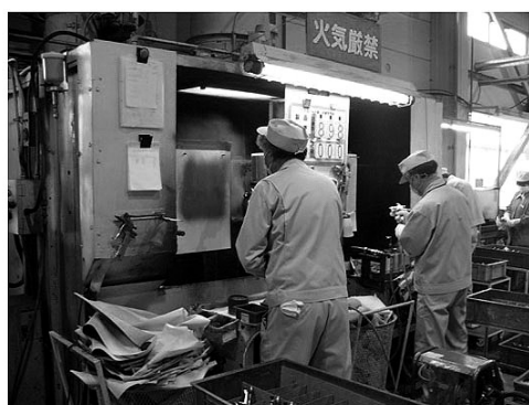
洗浄および空気漏れ確認作業（左）と溶剤噴霧状態の確認作業（右）
