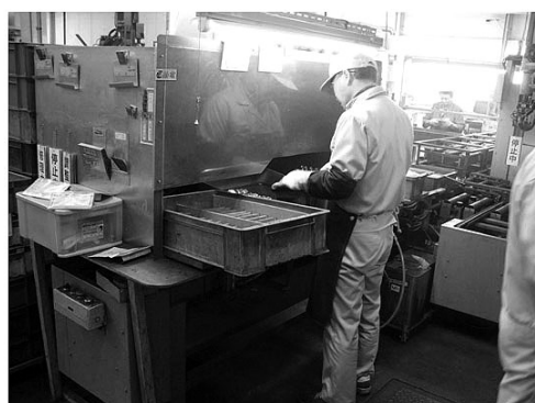
洗浄および空気漏れ確認作業（左）と溶剤噴霧状態の確認作業（右）
