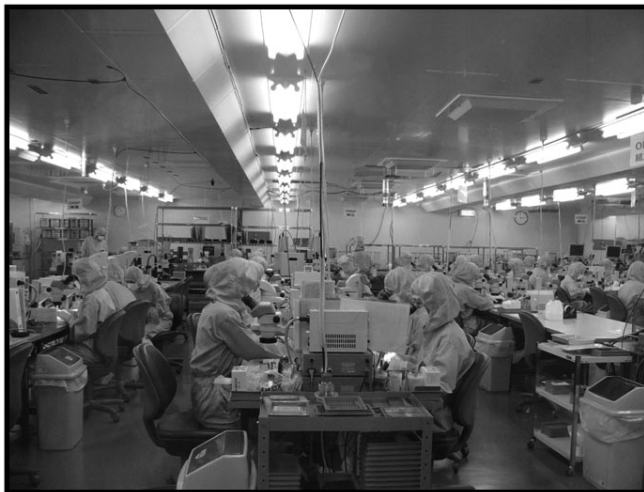
検査業務 1つ1つの結晶片を顕微鏡下で検査するとともに、汚れをアセトンないしメタノールで拭く
