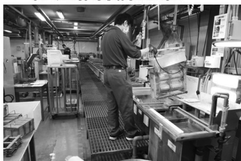
水洗浄場での滑り防止対策
