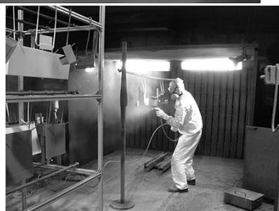
局所排気装置は写真奥にあるが、吹付け方向と吸引方向は90度ズレている（なお、塗装工は溶剤用の防毒マスク、保護眼鏡、保護手袋を着用していた）
