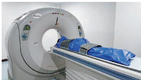
図2 Ai専用CT装置（東芝メディカルシステムズ社製64列CT） 遺体はビニール製ボディバッグに入れて撮像する。
